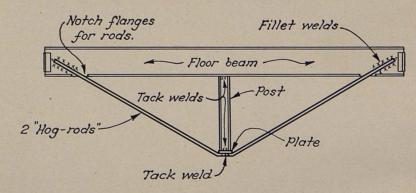
TRUSS BEAM METHOD OF STRENGTHENING FLOOR BEAMS
