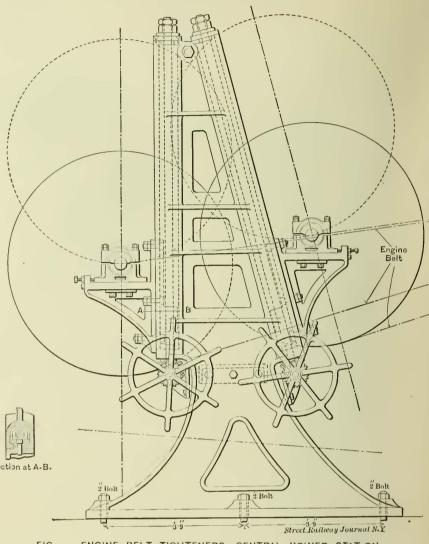
FIG. 3.—ENGINE BELT TIGHTENERS—CENTRAL POWER STATION.
