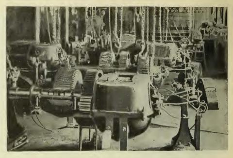
FIG. 12 -W. P. MOTORS COUPLED FOR TESTING.
