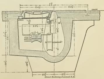
FIG. 7 .- CURVE PULLEY AND YOKE.
