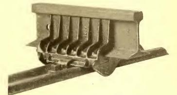
FIG. 84.-WHEELER RAIL JOINT.
