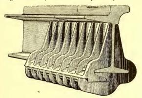
FIG. 83.-WHEELER RAIL JOINT.
