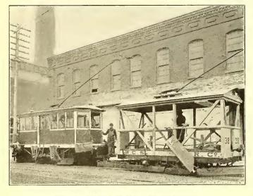
FIG. 4 .- SNOW PLOW AND SWEEPER.
