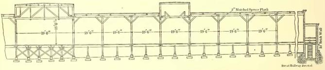
FIG. 2.--HALF LONGITUDINAL SECTION OF NEW CAR HOUSE-BOSTON.
