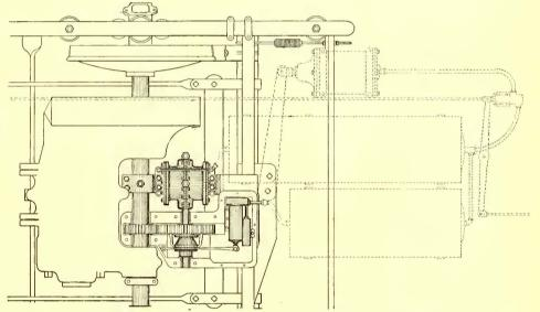
FIG. 2 .- AIR BRAKE EQUIPMENT FOR SINGLE TRUCK CAR.
