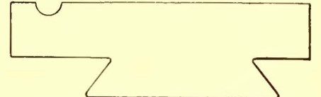
FIG. 10.—UNDER-CUT COMMUTATOR BAR
