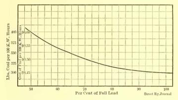
FIG. 2.--COAL CONSUMPTION UNDER VARIOUS PERCENTAGES OF LOAD
