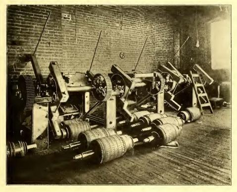
FIG. 11.—TESTING FRAMES FOR BRAKE TESTS OF ARMATURES
