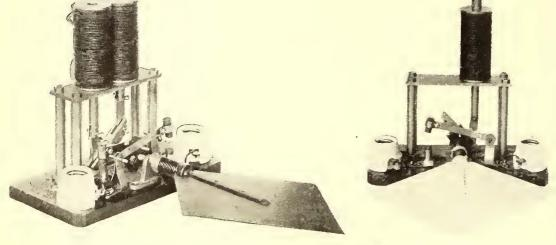
FIG. 5.-SOLENOIDS FOR RED SIGNAL
