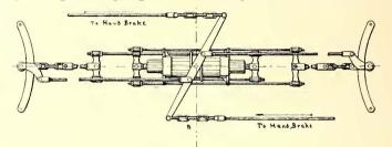
FIG. 3.-DUPLEX JAM CYLINDER, SHOWING HAND BRAKE CONNECTIONS
