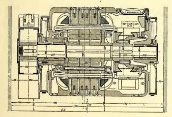
LONGITUDINAL SECTION OF INTER-POLE RAILWAY MO'10R
