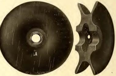
SIDE VIEW AND SECTION OF TROLLEY WHEEL
