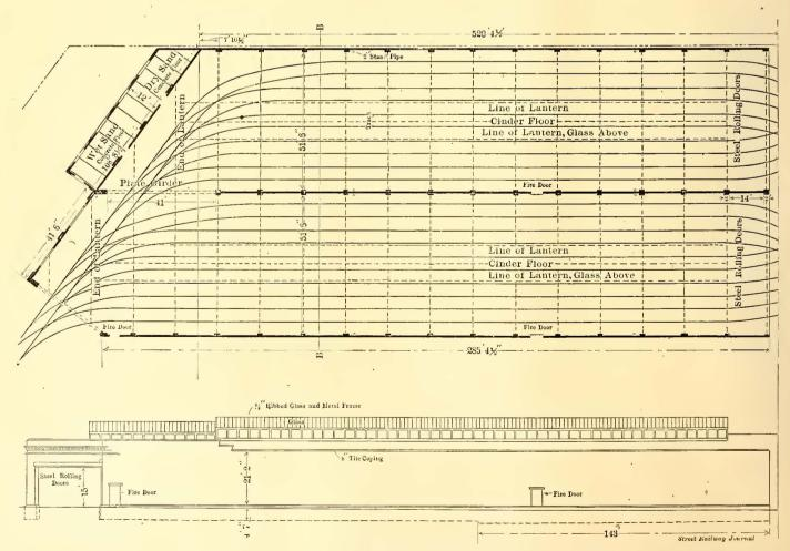
PLAN AND SIDE ELEVATION OF THE NEW COLD SPRING CAR HOUSE
