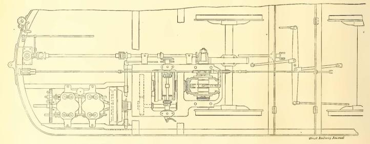
LAYOUT OF GASOLINE APPERATUS, BRAKE CONNECTIONS AND OTHER OPERATING DETAILS
