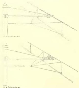
FIG. 2.—PYRAMIDAL GUYING TO WOOD STRAINS SHOWING BOTH ROLLER AND PETTICOAT INSULATORS, THE LATTER WITH AUXILIARIES
