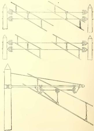
FIG. 4.—TYPES OF SPAN AND BRACKET CONSTRUCTION INTENDED FOR HIGH-VOLTAGE WORK
