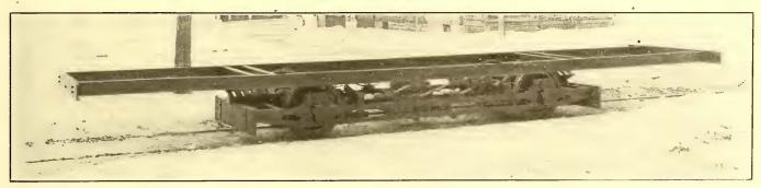
SIDE VIEW OF TRUCK CARRYING STEEL UNDER FRAME OF CAR BODY
