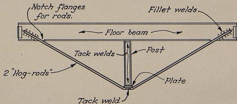
TRUSS BEAM METHOD OF STRENGTHENING FLOOR BEAMS
