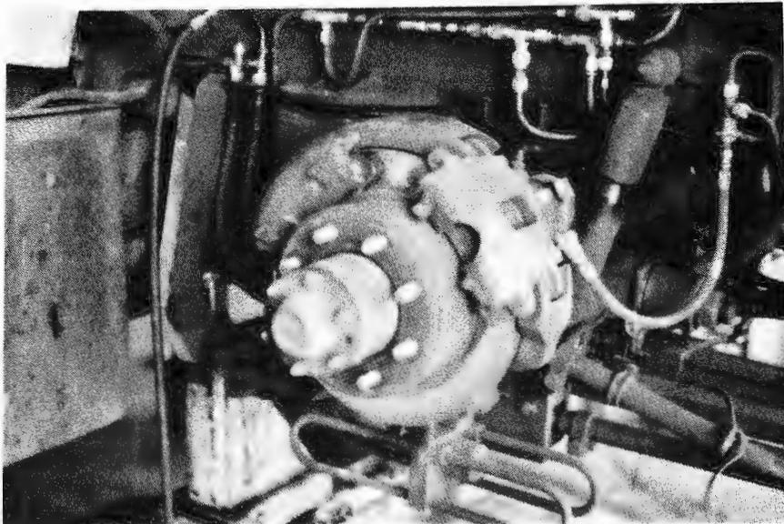
(b) VIEW OF HYDRAULIC DISC BRAKE
