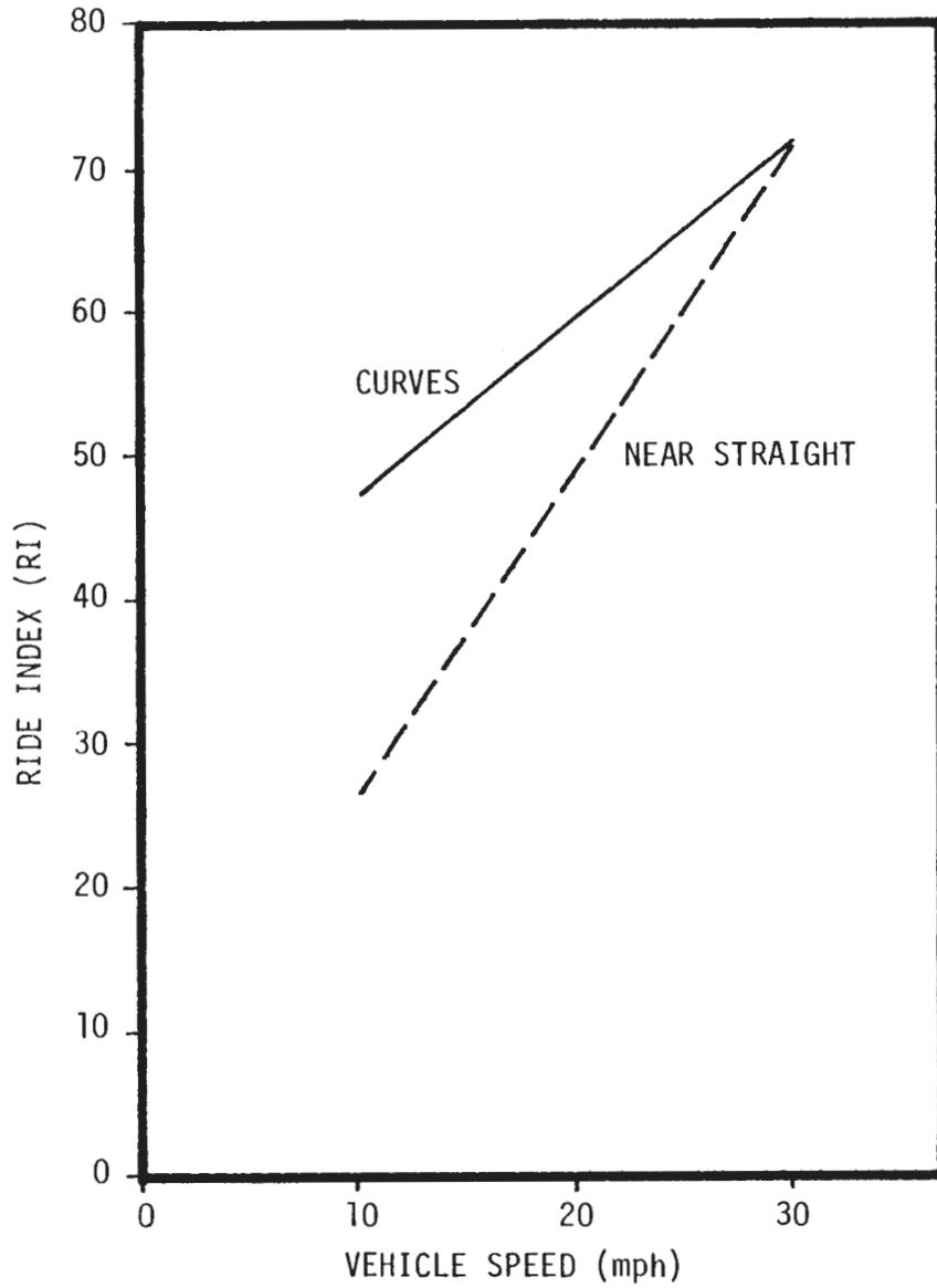
FIGURE 4.28a : MORGANTOWN VERTICAL RIDE INDEX VS VEHICLE SPEED
