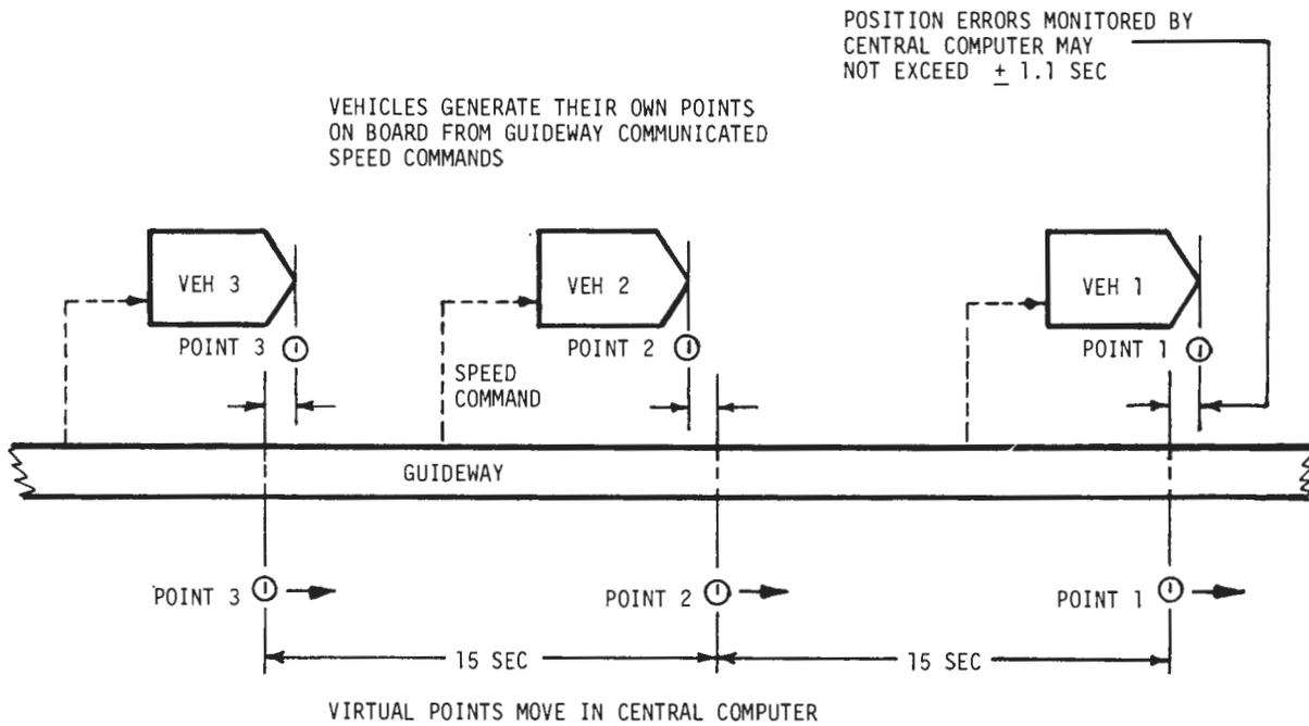
FIGURE 3.16 : SYNCHRONOUS VIRTUAL POINT FOLLOWER HEADWAY CONTROL
