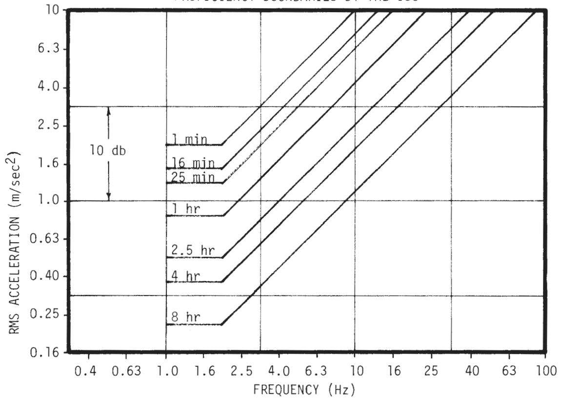
FIGURE 4.24 : HORIZONTAL ACCELERATION FATIGUE-DECREASED PROFICIENCY BOUNDARIES BY THE ISO
