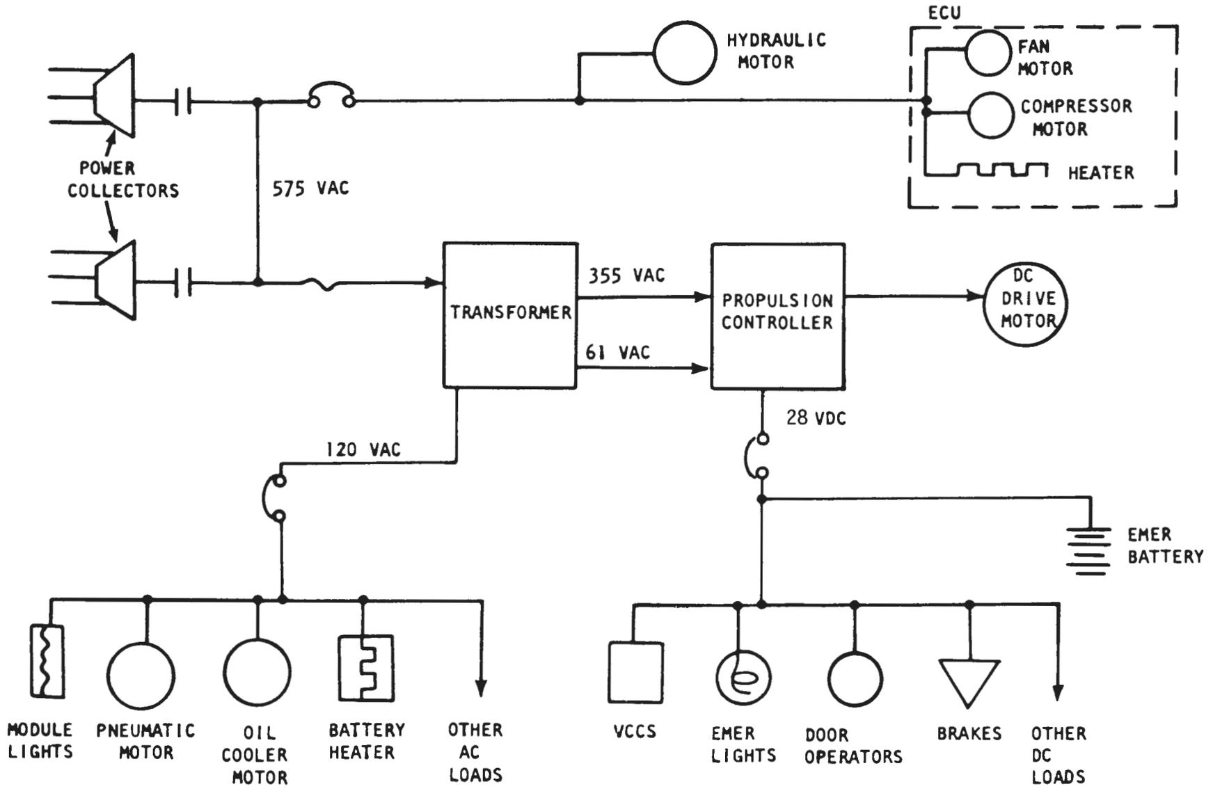
FIGURE 3.10 : VEHICLE ELECTRICAL SYSTEM
