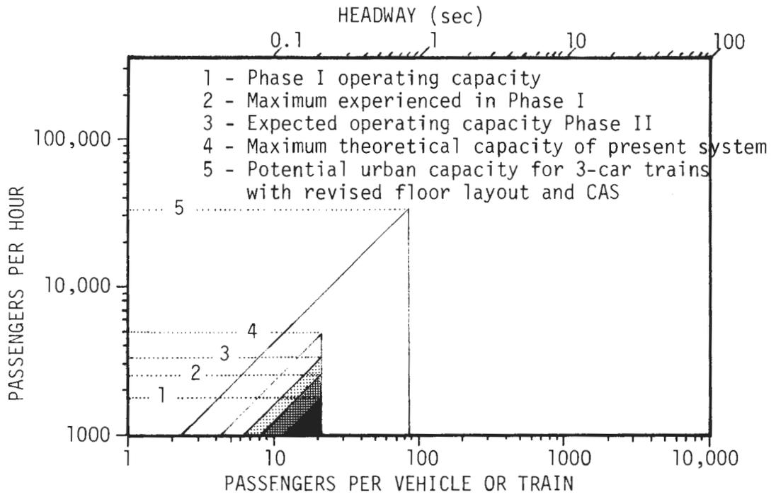
FIGURE 4.5 : SINGLE DIRECTION LINE CAPACITY
