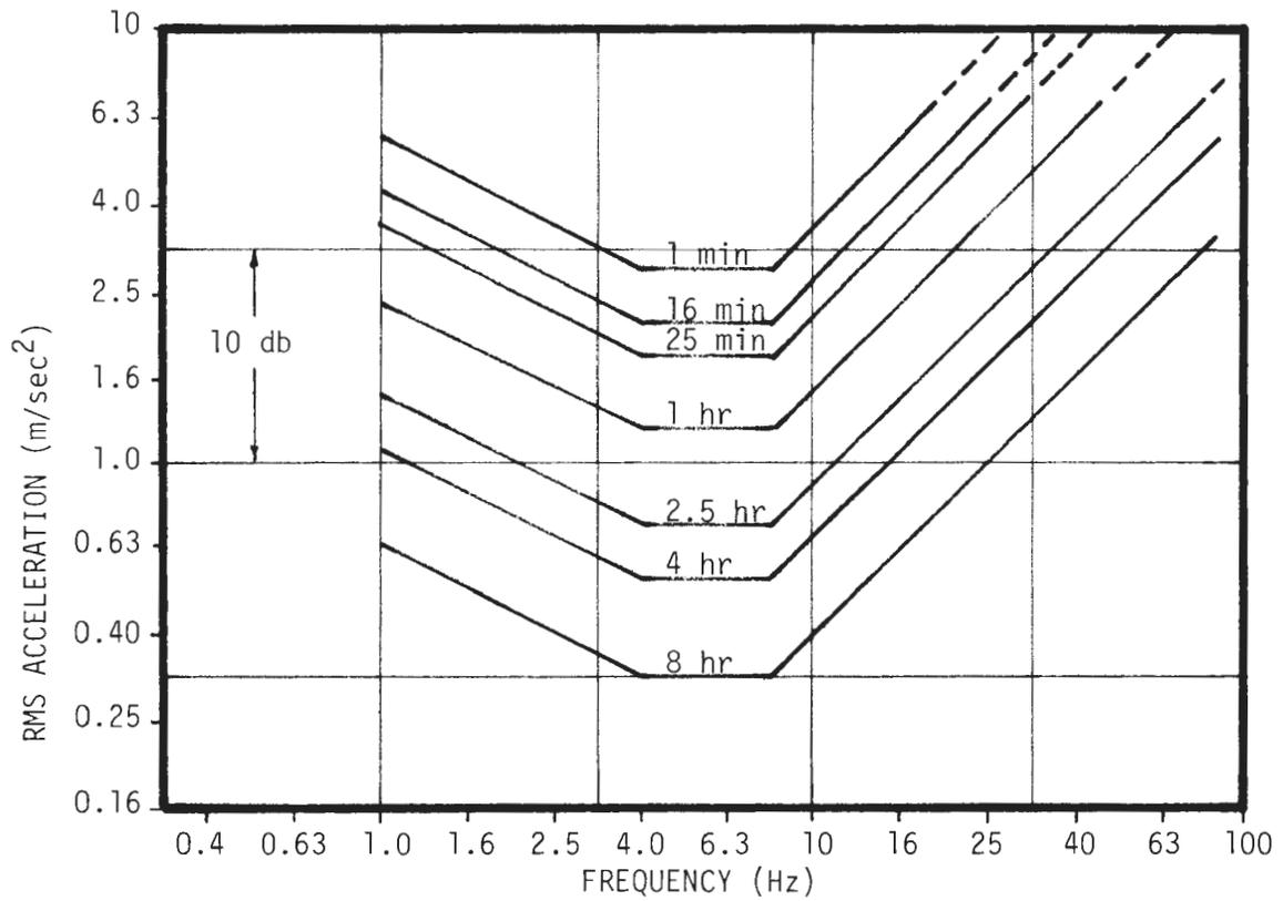
FIGURE 4.23 : VERTICAL ACCELERATION FATIGUE-DECREASED PROFICIENCY BOUNDARIES BY THE ISO
