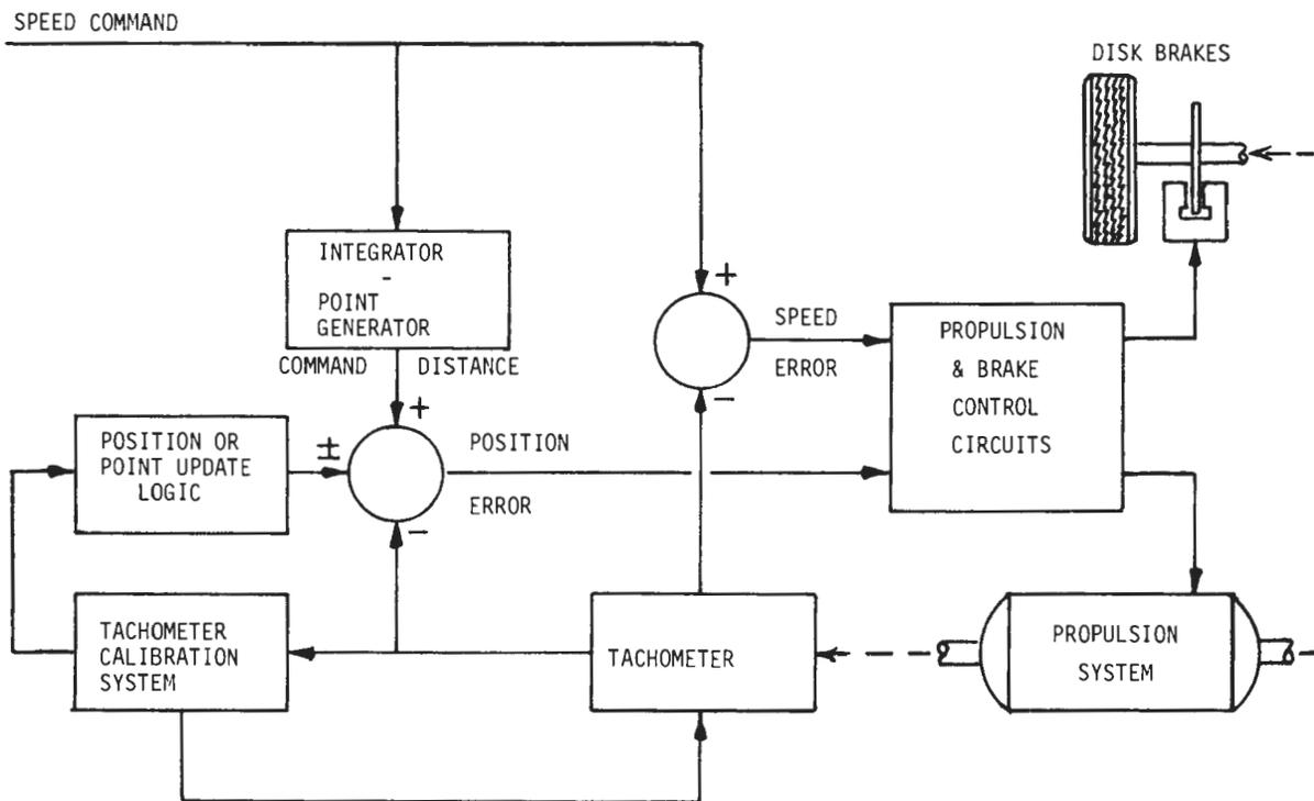
FIGURE 3.17 : SIMPLIFIED ON-BOARD LONGITUDINAL CONTROL SYSTEM
