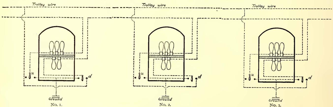
BLOCK SIGNAL SYSTEM FOR SINGLE TRACK ROADS.
