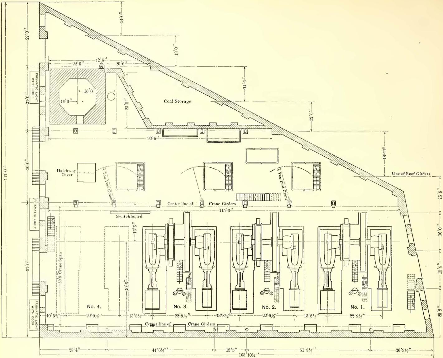
FIG. 3—PLAN OF ENGINE ROOM—LOOP POWER STATION
