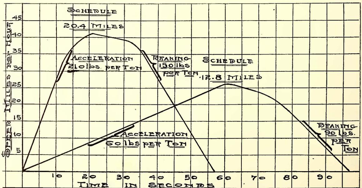
FIG. 6—CURVES SHOWING ACCELERATION OF MANHATTAN STEAM LOCOMOTIVE AND SPECIAL ELECTRIC CAR
