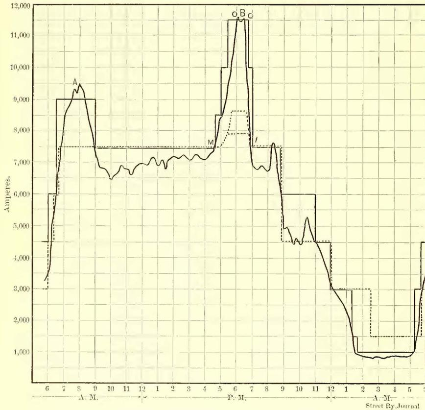
FIG. 1.—LOAD DIAGRAM FROM TYPICAL LARGE STATION
