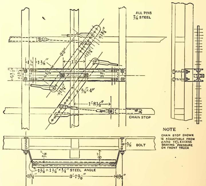
FIG. 4.—DIFFERENTIAL BRAKE RIGGING
