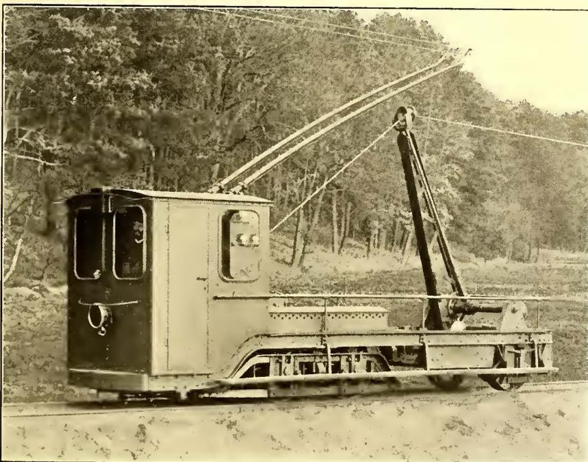
ELECTRIC LOCOMOTIVE USED ON THE TELTOW CANAL
