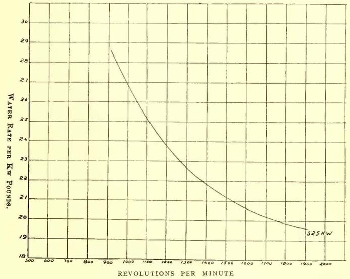
FIG. 2.—500-KW CURTIS TURBINE AT NEWPORT, R. I., CURVE SHOWING EFFECT OF SPEED ON STEAM CONSUMPTION (WATER RATE PER KW-HOUR)
