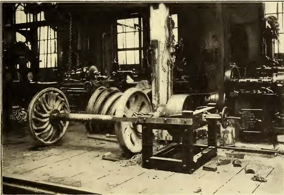
FIG. 3.—MACHINE FOR DRILLING THE HUBS OF CAST-IRON WHEELS
