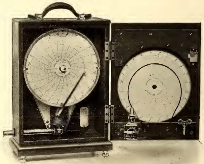
FIG. 2.—GAS PRESSURE OR LIGHT VACUUM GAGE
