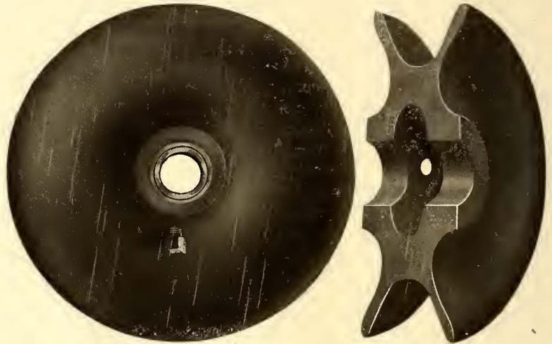
SIDE VIEW AND SECTION OF TROLLEY WHEEL
