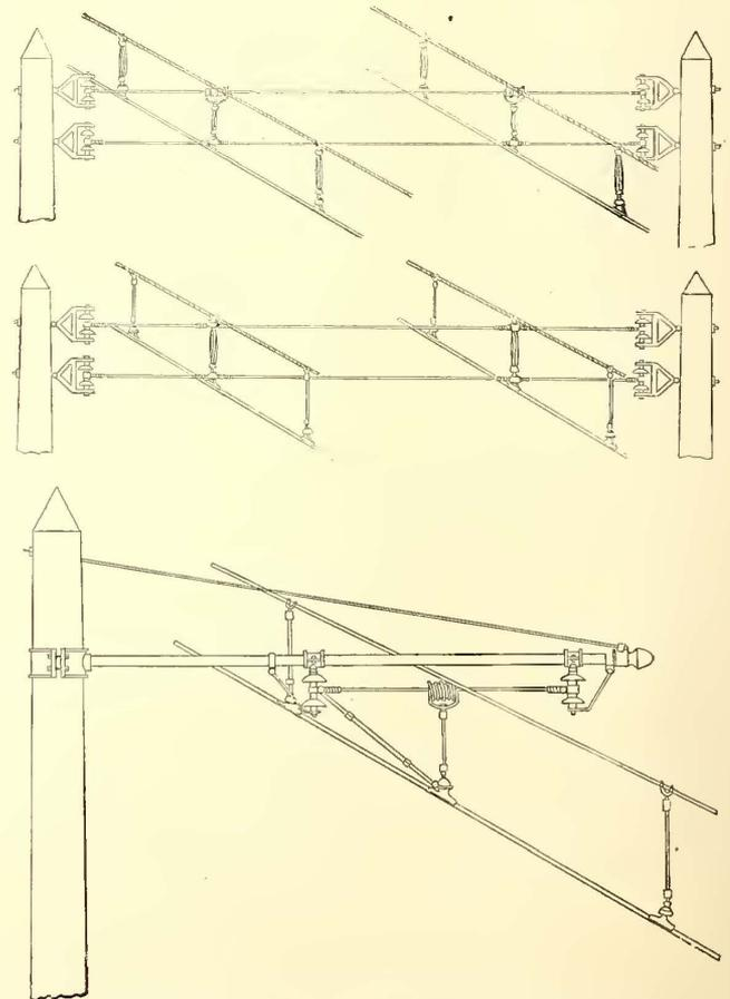
FIG. 4.—TYPES OF SPAN AND BRACKET CONSTRUCTION INTENDED FOR HIGH-VOLTAGE WORK
