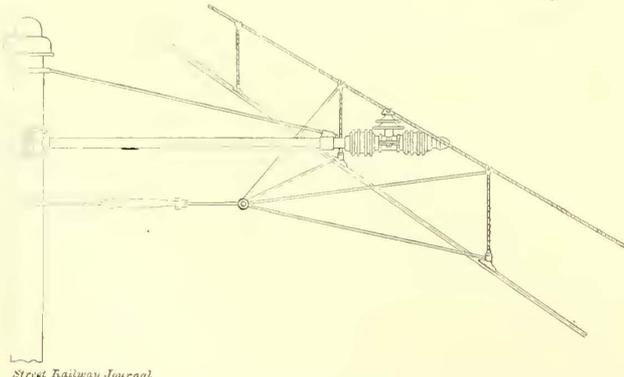
FIG. 2.—PYRAMIDAL GUYING TO WOOD STRAINS SHOWING BOTH ROLLER AND PETTICOAT INSULATORS, THE LATTER WITH AUXILIARIES
