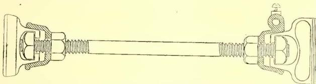
FIG. 6.—SUSPENDER WITH INTERCHANGEABLE STRAIN AND FEED CAPS
