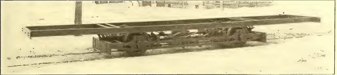
SIDE VIEW OF TRUCK CARRYING STEEL UNDER FRAME OF CAR BODY
