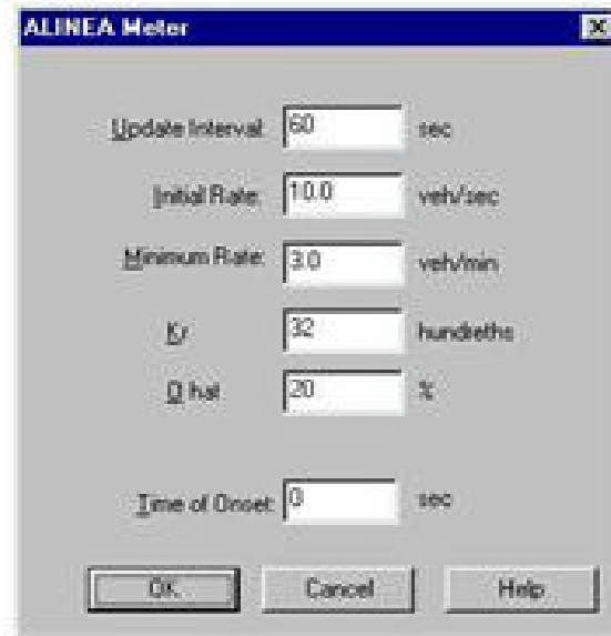
Figure 4-10: ALINEA ramp meter input parameters (CORSIM Manual)
