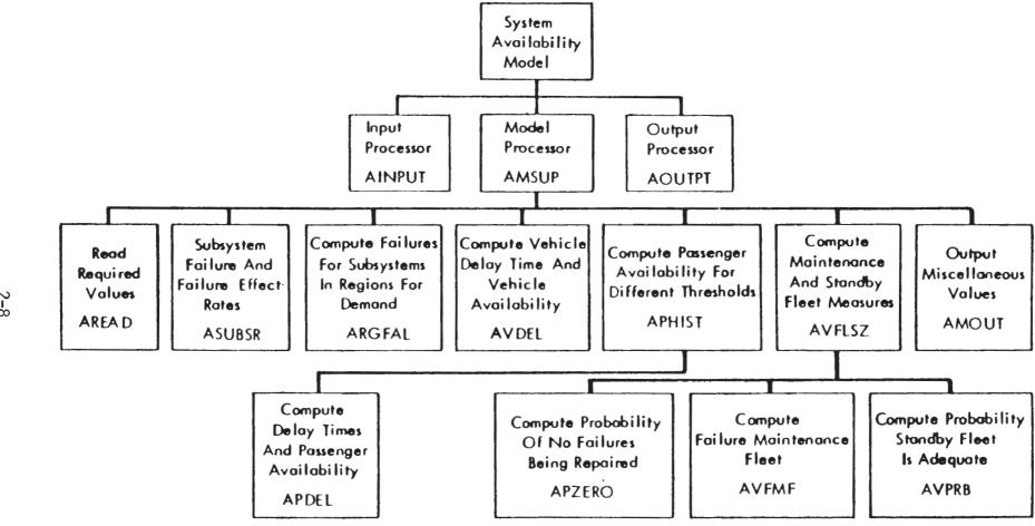
FIGURE 2-4. SAM BLOCK DIAGRAM STRUCTURE
